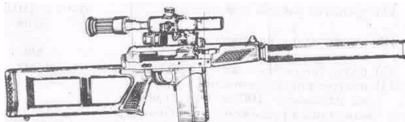
Рис. 20. Винтовка снайперская ВСК-94. Общин вид.
